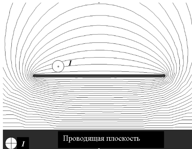
Рис. 3. Качественная картина распределения магнитного поля в электродной системе в случае сильного скин-эффекта.
