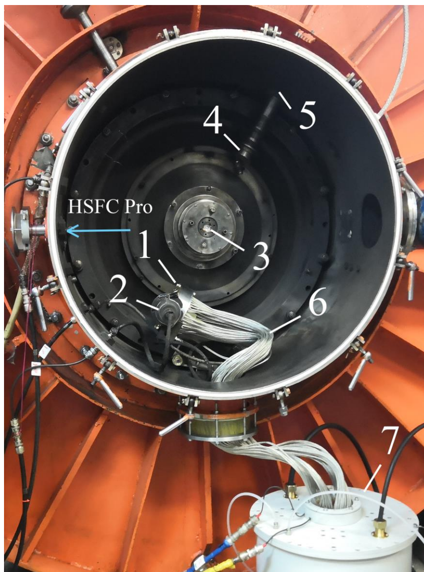
Рис.4. Фотография узла нагрузки генератора МИГ. 1 – узел нагрузки (камера) X-пинча; 2 – ВРД; 3 – нагрузка с обратным токопроводом генератора МИГ; 4 – узел диафрагм; 5 – фотопленки; 6 – гибкая низкоиндуктивная многокабельная линия; 7 – генератор XPG-3 X-пинча.
